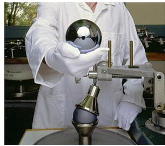
*Figura 2 esfera de um monocristal de silício 93,6mm de diâmetro que apresente condições técnicas precisas o suficiente para ganhar o status de padrão para o quilograma.*
