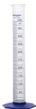
Proveta: medida aproxima de volumes líquidos. Pode ser encontradas nas mais variadas capacidades volumétricas
