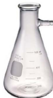
Kitassato: filtrações à vácuo
