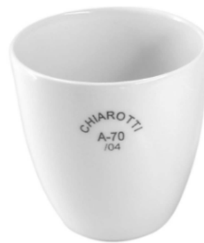
Cadinho de porcelana: aquecimento de sólidos a temperaturas elevadas
