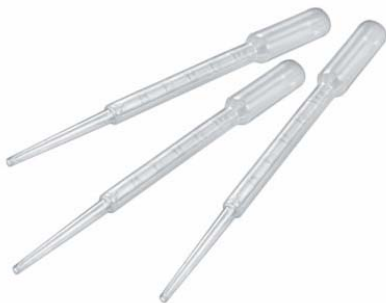
Pipeta de Pasteur: medida e transferência de líquidos
