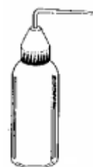
Pisseta: lavagens, remoção de precipitados e outros fins
