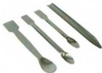
Espátula: retirada de porções de reagentes sólidos
