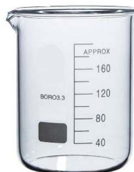
Béquer (copo de Béquer): transferência de líquidos e aquecimento
