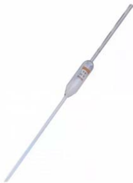
Pipeta volumétrica: medida de volumes fixos de líquidos. Encontradas de diversas capacidades
