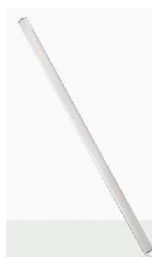
Bastão de vidro: agitar soluções, transporte de líquidos, filtração e outro fins diversos
