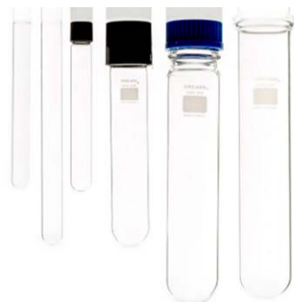
Tubo de ensaio: teste de reações químicas. Pode ser de os mais variados tamanhos, nas versões com ou sem tampa
